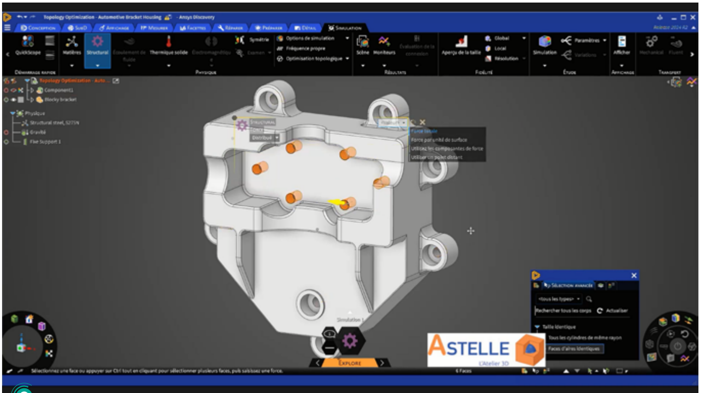
Phase de mise en données du calcul avant optimisation topologique.
